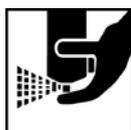
Pour nettoyer la buse, il faut retourner le récipient et activer l'aérosol pour un certain temps. Le propulseur poussera les résidus hors de la buse, les empêchant de sécher et permettant ainsi de réutiliser l'aérosol.
